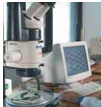
Control de dimensiones con estudio microscópico y electrónico de la malla de metal estirado
