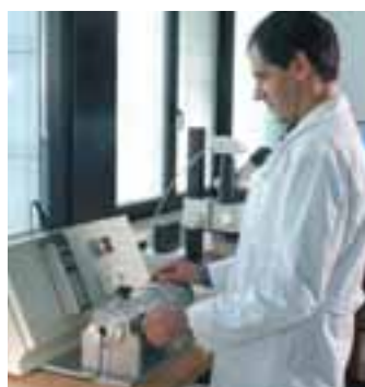
Dispositivo de laboratorio para el control del porcentaje de vacío de la malla de metal estirado
