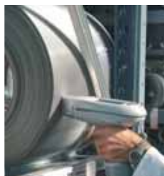
Instrumento para el reconocimiento electrónico de la composición química de la materia prima
